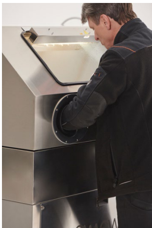
In het afgesloten compartiment van de onderdelenreiniger wordt met hoge druk gewerkt tot 80 bar. (Foto: Mewa)
