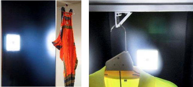
Kwaliteitscontrole voor signalisatiekleding: het nieuwe procedé zorgt voor geautomatiseerde controle van de kleureigenschappen en reflecterende werking van de kleding na het wassen (Foto's: Fraunhofer IGD)
