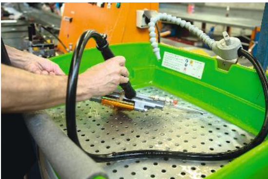
Onderdelen worden gereinigd met behulp van een biologische reinigingsvloeistof (Foto: MEWA)
